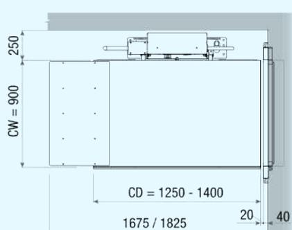
VISTA SUPERIOR: dimensões máximas globais com a plataforma colocada
